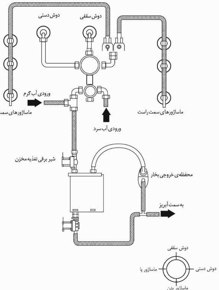
اگر دستگیره‌ی توزیع کننده آب را در حالت وسط قرار دهید، دوش سقفی فعال می‌شود. در موقعیت سمت چپ ماساژورهای پا فعال می‌شود. همچنین در موقعیت سمت راست آب از دوش سیار خارج می‌شود و هنگامی که دستگیره در موقعیت پایین قرار می‌گیرد، جریان آب در ماساژورهای بدن برقرار می‌شود.
